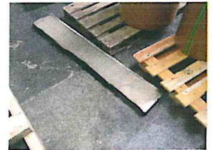
Plaque isolante qui tombe du toit (cis LREM)
